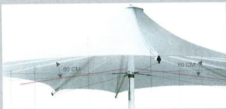
DISTANCE ENTRE PARASOL ET AMPOULES: 80 CM
